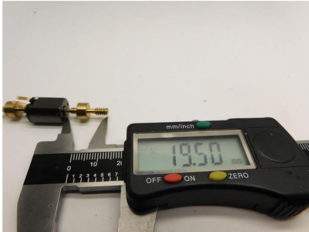
Maße prüfen Check dimensions Controleer de maatvoering
