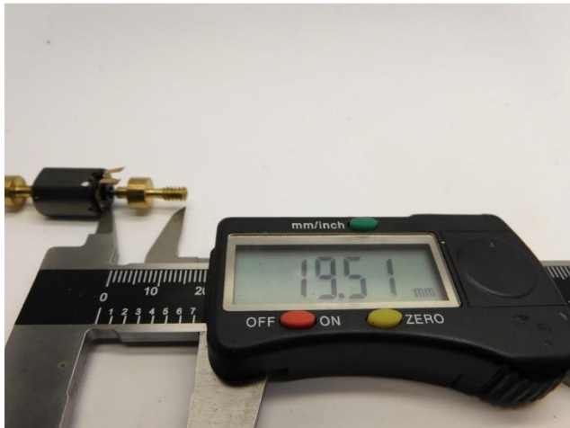
Maße prüfen Check dimensions Controleer de maatvoering
