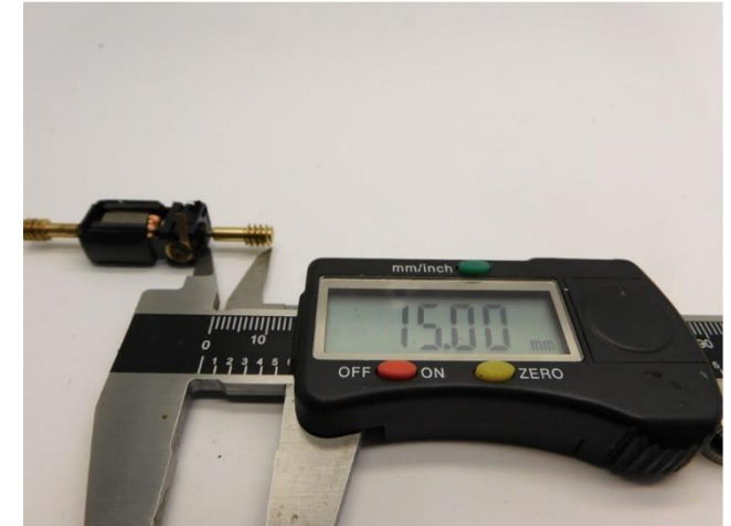
Maße prüfen Check dimensions Controleer de maatvoering
