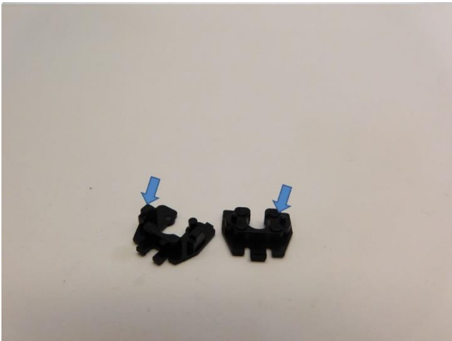
Feilen Sie die Motorhalter schmaler File the motor holders narrower Vijl de motorhouders smaller
