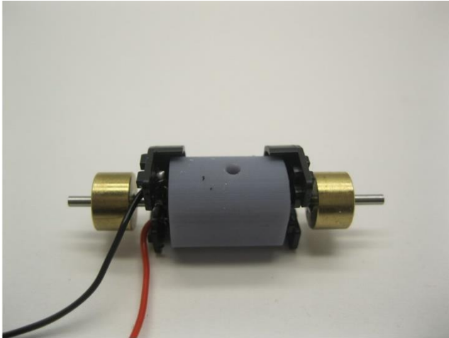
Die Schwungmassen sind verklebt The flywheels are glued De vliegwielen zijn verlijmd
