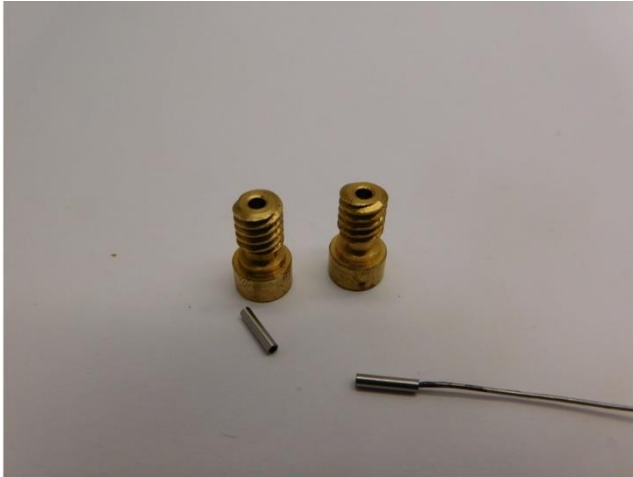
Tragen Sie Klebstoff auf die Innenseite des Teile Apply glue on the inside of the parts Plaats alleen lijm aan de binnenzijde van de onderdelen
