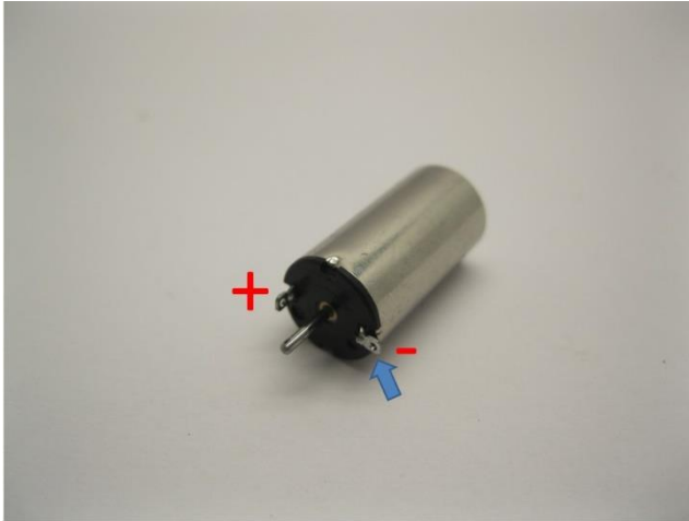
Biegen Sie die Kontakte wie im Bild gezeigt Bend the contact as shown in the picture Buig het contact zoals in de afbeelding
