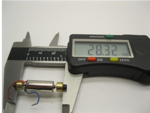
Maße prüfen Check dimensions Controleer de maatvoering
