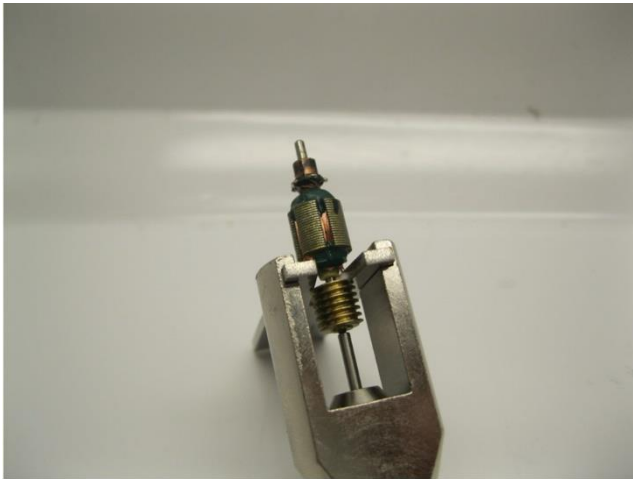
Entfernen Sie das Ritzel vom alten Motor Remove the gear from old motor Verwijder het tandwiel van de motor
