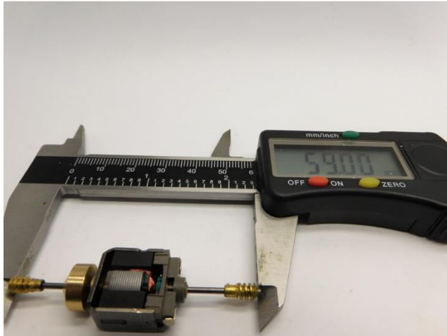
Maße prüfen Check dimensions Controleer de maatvoering
