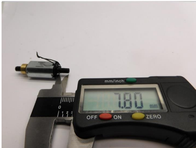
Maße prüfen Check dimensions Controleer de maatvoering
