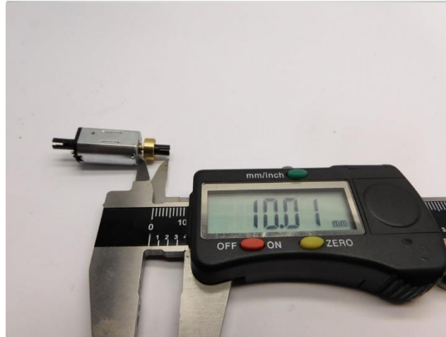
Maße prüfen Check dimensions Controleer de maatvoering
