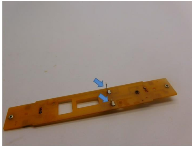
Alter Motorkontakt entfernen Remove old motor contacts Verwijder de oude motorcontacten
