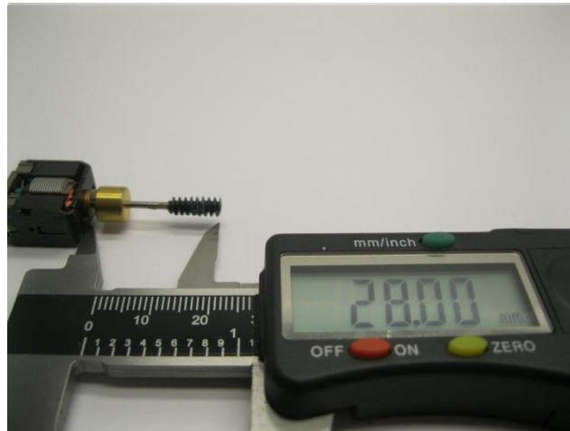
Maße prüfen Check dimensions Controleer de maatvoering
