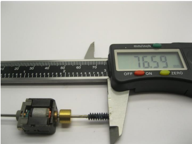
Maße prüfen Check dimensions Controleer de maatvoering
