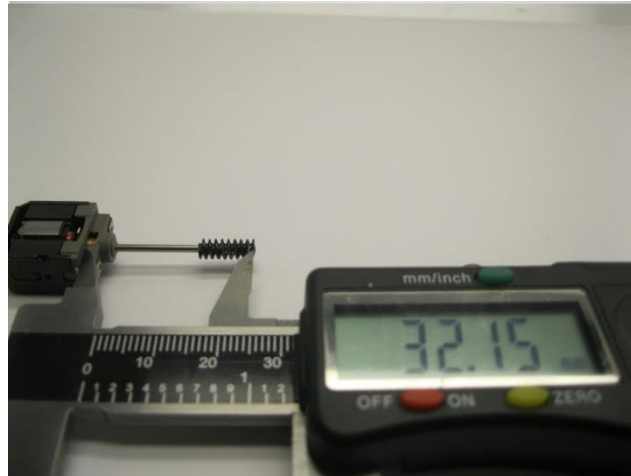
Maße prüfen Check dimensions Controleer de maatvoering
