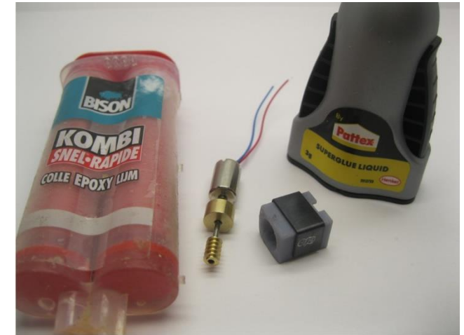
Der Motor wird mit Epoxidkleber oder Sekundenkleber in den Motorhalter eingeklebt The motor is glued into the motor holder with epoxy glue or super glue De motor wordt verlijmd in de motorhouder met secondelijm of epoxy lijm
