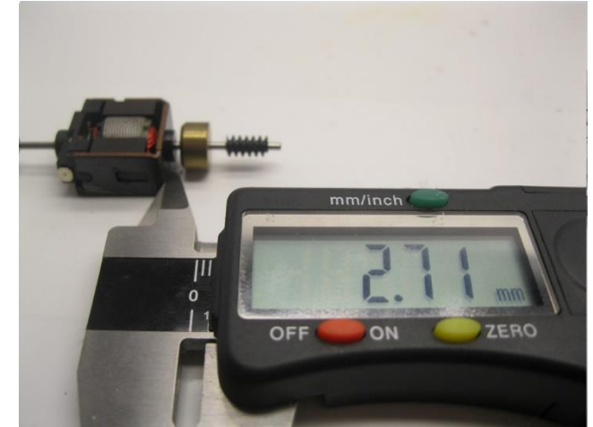
Maße prüfen Check dimensions Controleer de maatvoering
