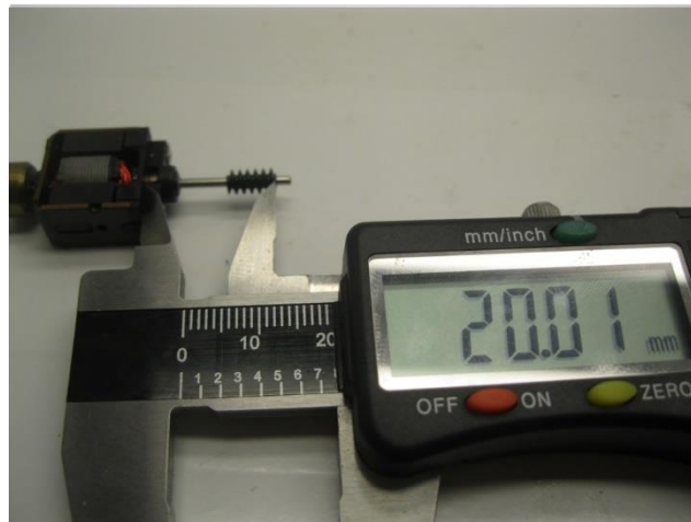
Maße prüfen Check dimensions Controleer de maatvoering
