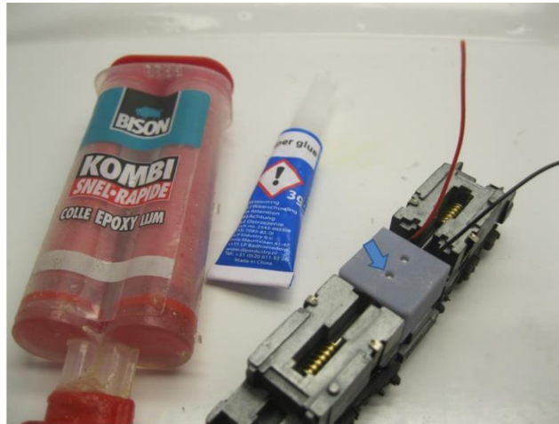
Der Motor wird mit Epoxidkleber oder Sekundenkleber in den Motorhalter eingeklebt The motor is glued into the motor holder with epoxy glue or super glue De motor wordt verlijmd in de motorhouder met secondelijm of epoxy lijm
