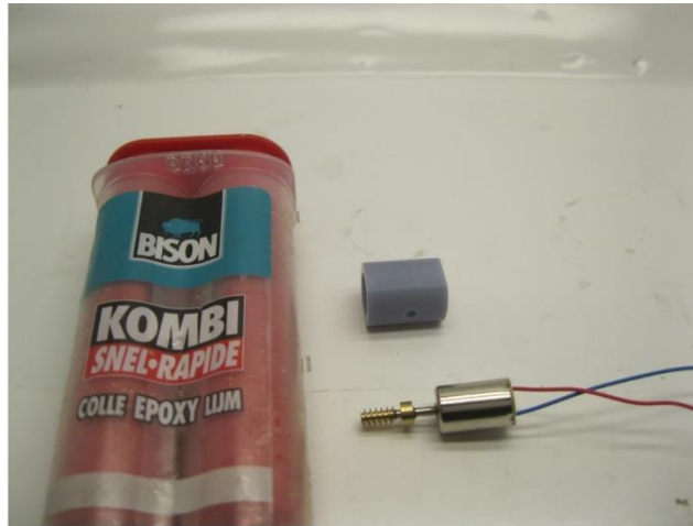
Der Motor wird mit Epoxidkleber oder Sekundenkleber in den Motorhalter eingeklebt The motor is glued into the motor holder with epoxy glue or super glue De motor wordt verlijmd in de motorhouder met secondelijm of epoxy lijm
