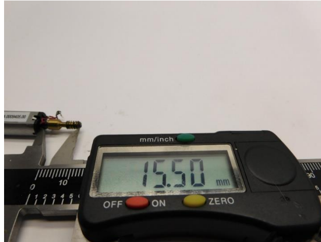
Maße prüfen Check dimensions Controleer de maatvoering
