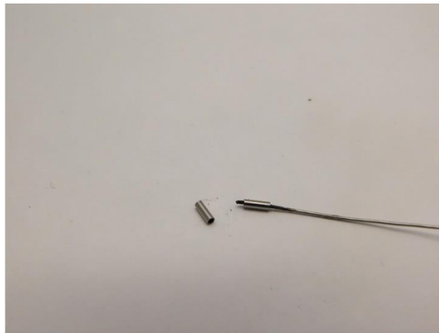
Tragen Sie Klebstoff auf die Innenseite des Teil Apply glue on the inside of the part Plaats alleen lijm aan de binnenzijde van de onderdelen
