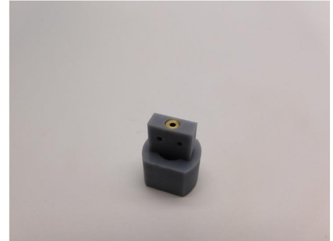
Der Lager wird mit Epoxidkleber oder Sekundenkleber in den Motorhalter eingeklebt The bearing is glued into the motor holder with epoxy glue or super glue Het lager wordt met epoxylijm of secondelijm verlijmd
