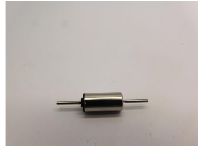
Die erste Metallteile sind geklebt The first metal parts are glued De eerste metaaldelen zijn verlijmd
