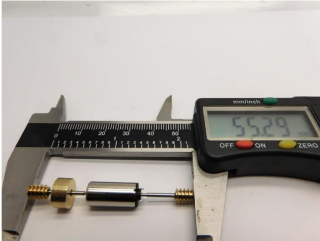
Maße prüfen Check dimensions Controleer de maatvoering
