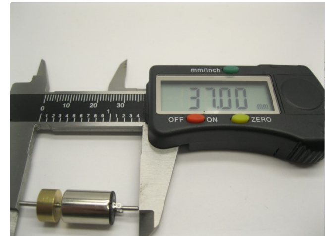
Maße prüfen Check dimensions Controleer de maatvoering
