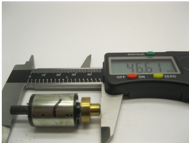
Maße prüfen Check dimensions Controleer de maatvoering
