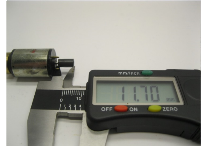
Maße prüfen Check dimensions Controleer de maatvoering
