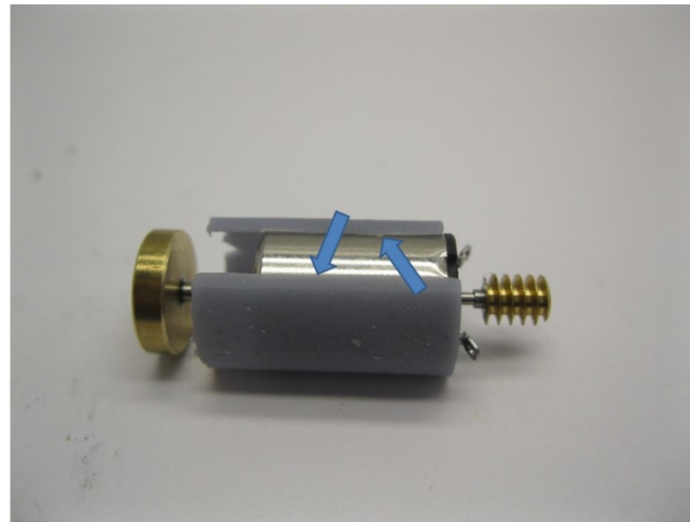
Der Motor wird mit Epoxidkleber oder Sekundenkleber mit den Motorhalterteilen verklebt The motor is glued with the motor holder parts with epoxy glue or super glue De motor wordt verlijmd in de motorhouder delen met secondelijm of epoxy lijm
