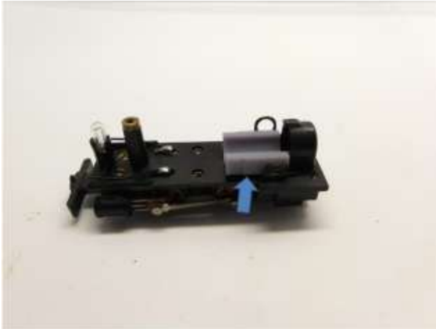
Der Motorhalter wird mit Epoxidkleber oder Sekundenkleber geklebt The motor holder is glued with epoxy glue or super glue De motorhouder wordt verlijmd met secondelijm of epoxy lijm
