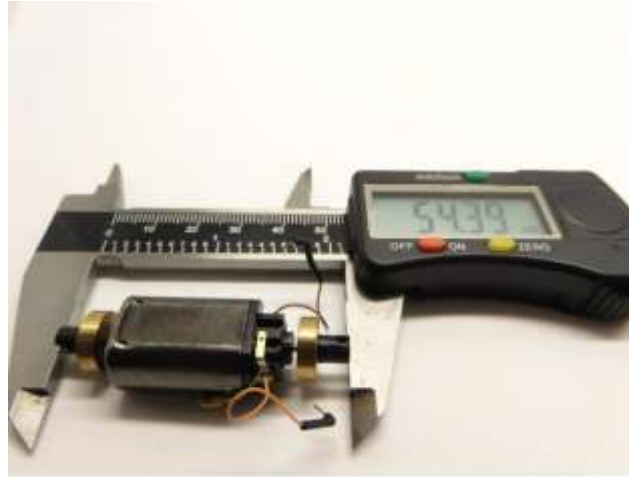
Maße prüfen Check dimensions Controleer de maatvoering
