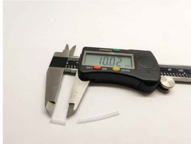
Schneiden Sie ein 10 mm langes Stück der Schlauchkupplung ab Cut an 10 mm section of the hose coupling Snij een stuk van 10 mm slangkoppeling
