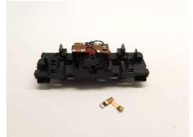
Alter Motorkontakt entfernen Remove old motor contacts Verwijder de oude motorcontacten
