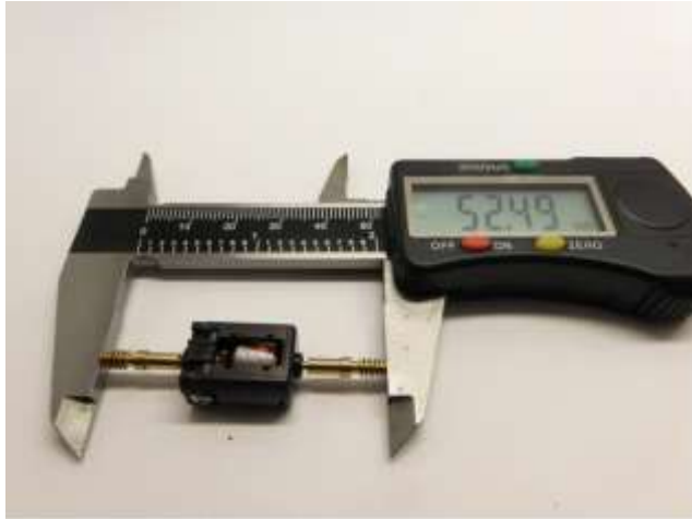
Maße prüfen Check dimensions Controleer de maatvoering
