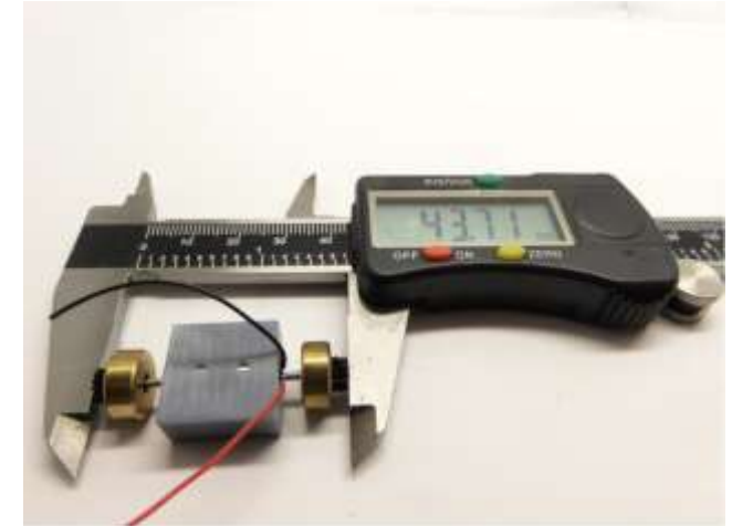
Maße prüfen Check dimensions Controleer de maatvoering
