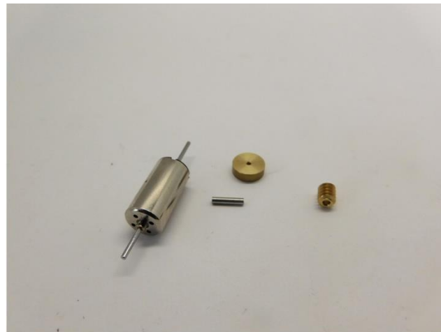
Metall Teile werden mit Loctite oder Metal Epoxy Kleber verklebt Metal parts are glued with Loctite or metal epoxy glue Metalen onderdelen worden gelijmd met metaallijm voor metalen
