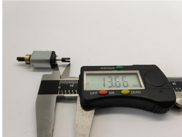
Maße prüfen Check dimensions Controleer de maatvoering
