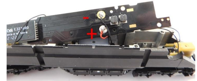
Drähte löten Solder the wires Soldeer de draden
