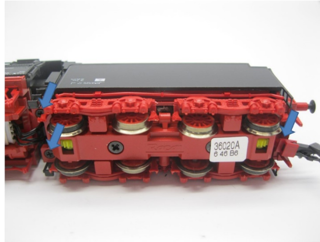
Gehäuse entfernen Remove housing Verwijder de kap
