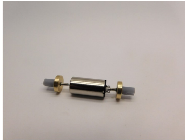
Kleben Sie die Kardankupplungen Glue the cardan couplers Verlijm de cardan koppelingen
