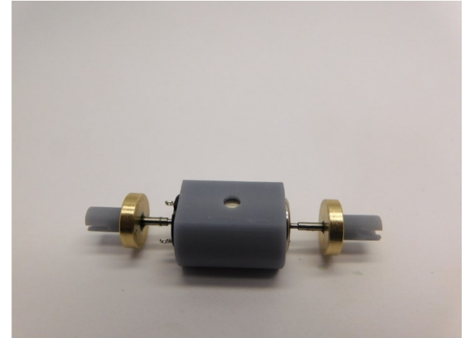
Motor im Motorhalter platzieren Place motor in motor holder Plaats de motor in de motor houder
