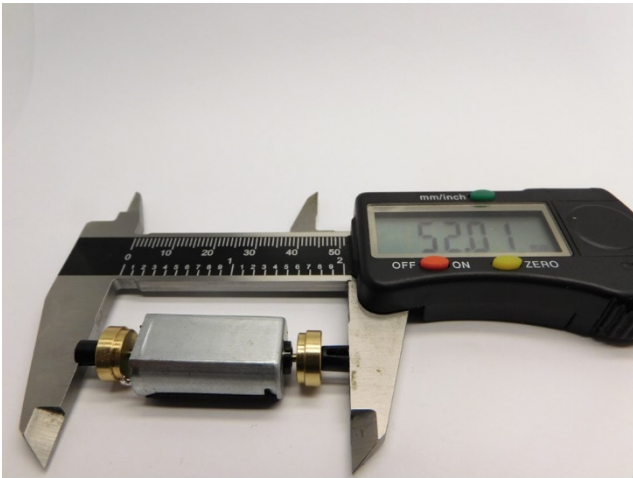
Maße prüfen Check dimensions Controleer de maatvoering
