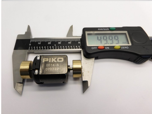
Maße prüfen Check dimensions Controleer de maatvoering
