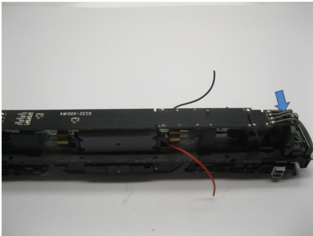
Leiterplatte platzieren Mount circuit board Plaats de printplaat
