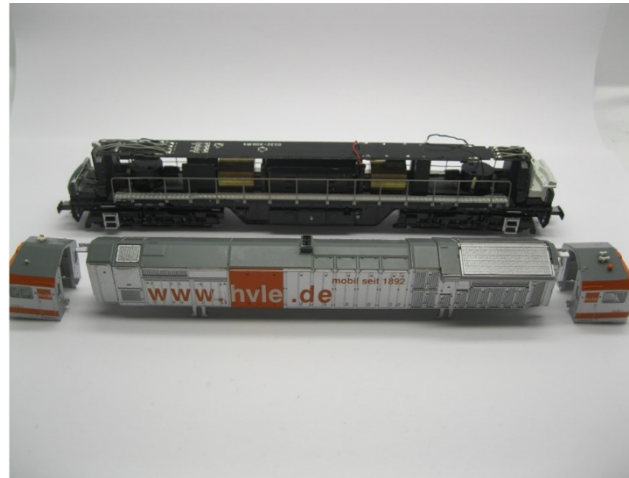
Gehäuse entfernen Remove housing Verwijder de kap
