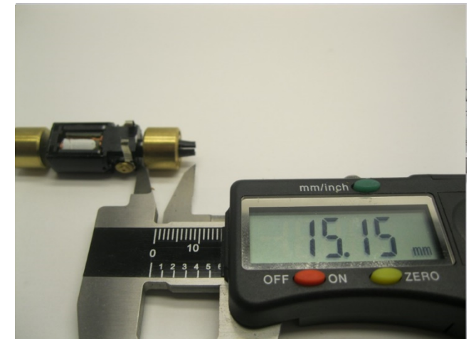
Maße prüfen Check dimensions Controleer de maatvoering
