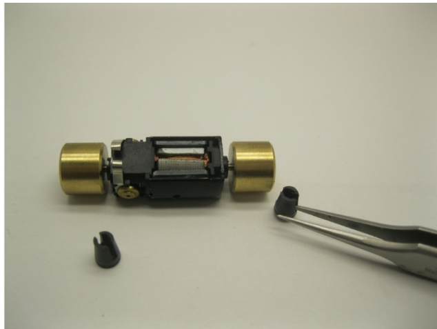
Sie brauchen die Teile wieder. Diese werden mit einer Pinzette entfernt You need the parts again. They can be removed with tweezers Je hebt deze onderdelen wederom nodig. Ze kunnen met een pincet verwijderd worden
