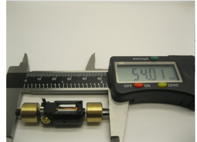
Maße prüfen Check dimensions Controleer de maatvoering
