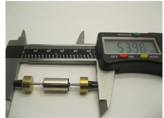
Die Kardankupplungen werden mit 2-Komponenten-Epoxidkleber oder Sekundenkleber verklebt The cardan couplings are glued with 2-component epoxy glue or superglue De kardankoppelingen worden met 2-componenten epoxy of met secondelijm verlijmd
