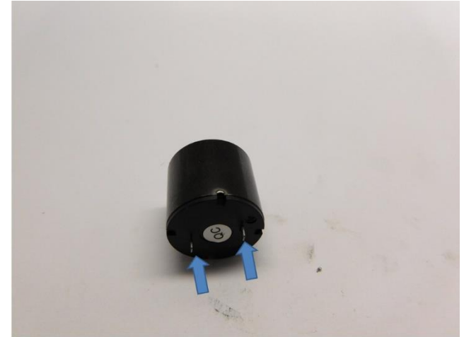
Biegen Sie die Lötlippen Bend the soldering lips Buig de soldeerlippen
