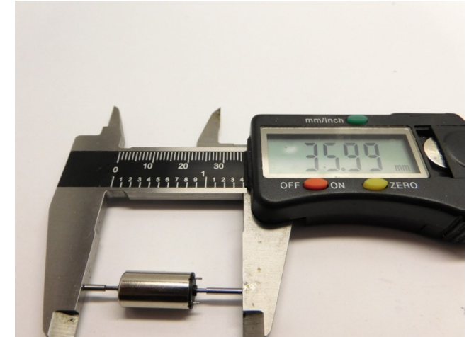
Maße prüfen (8 mm Wellen) Check dimensions (8 mm shafts) Controleer de maatvoering
