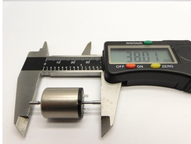
Maße prüfen Check dimensions Controleer de maatvoering
