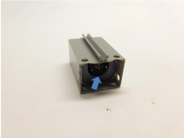
Der Motor wird mit Epoxidkleber oder Sekundenkleber in den Motorhalter eingeklebt The motor is glued into the motor holder with epoxy glue or super glue De motor wordt verlijmd met secondelijm of epoxy lijm
