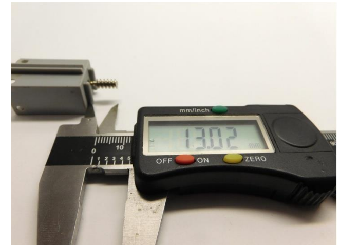
Maße prüfen Check dimensions Controleer de maatvoering
