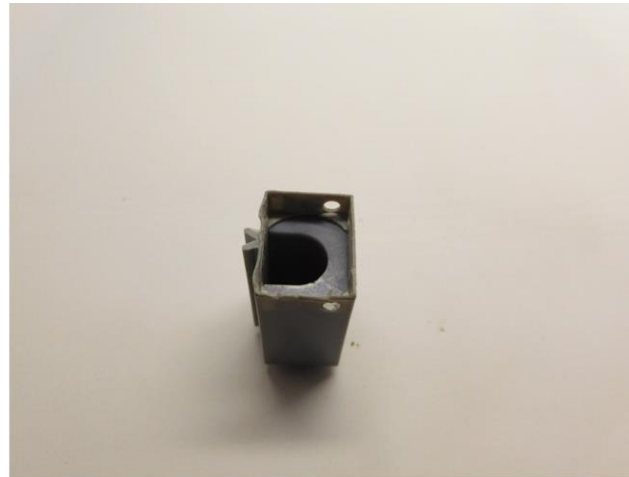
Motorhalter in Gehäuse kleben Glue motorholder in housing Verlijm de motorhouder in de behuizing
