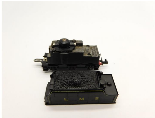
Gehäuse entfernen Remove housing Verwijder de kap
