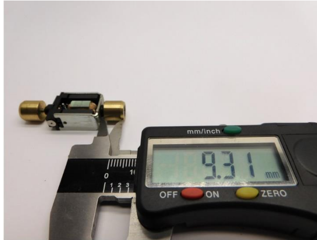
Maße prüfen Check dimensions Controleer de maatvoering
