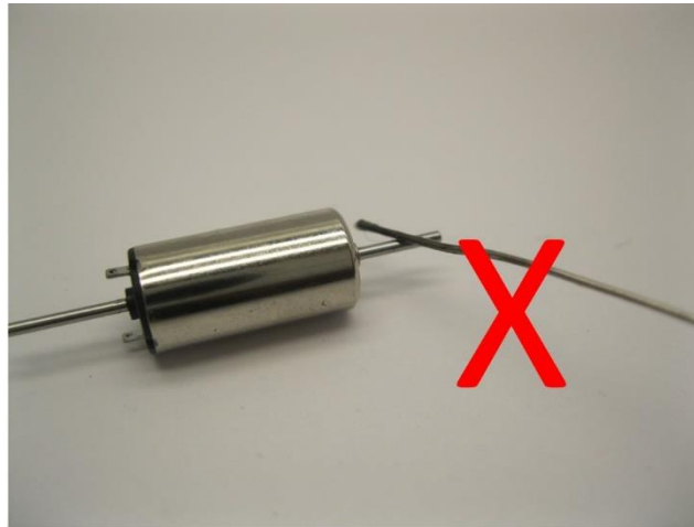
Tragen Sie keinen Kleber auf die Achse auf Don't apply glue on the axle Plaats geen lijm op de as
