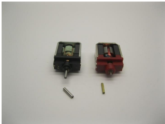
Die meisten Roco-Motoren haben 1,5 mm Wellen, einige alte Motoren 1,2 mm. Verwenden Sie nur die richtigen! Most Roco motors have 1.5 mm shafts, some old motors 1.2 mm. Only use the correct ones! De meeste Roco motoren hebben 1.5 mm assen, sommige oude 1.2 mm. Gebruik alleen de juiste!
