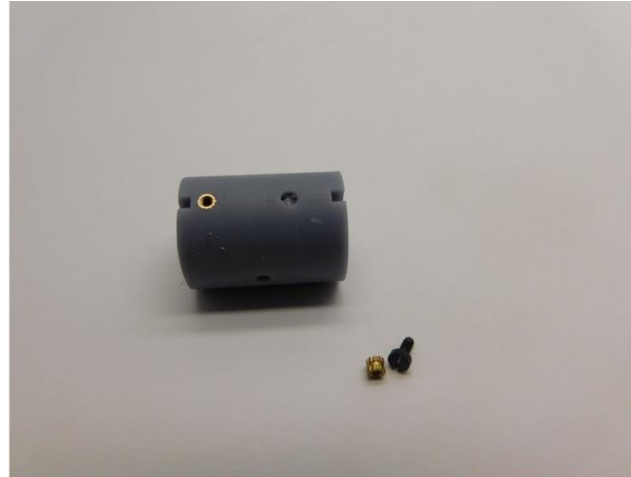
Die Messingeinsätze werden mit Sekundenkleber in den Motorhalter eingeklebt The brass inserts are glued into the motor holder with superglue De messing inserts worden met secondelijm in de motor houder verlijmd
