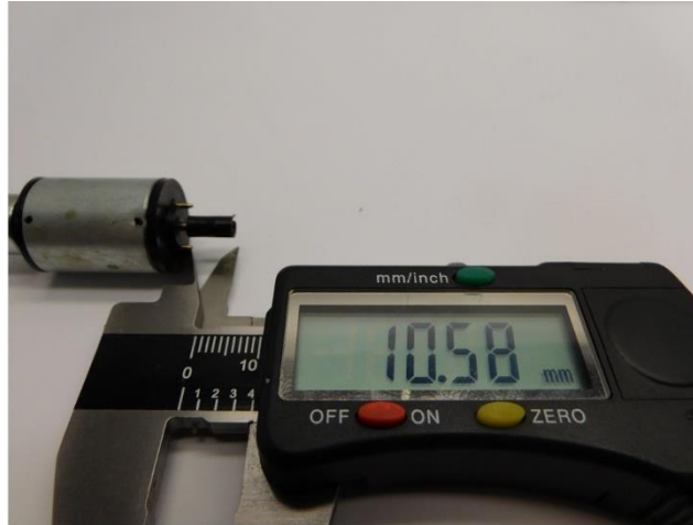
Maße prüfen Check dimensions Controleer de maatvoering
