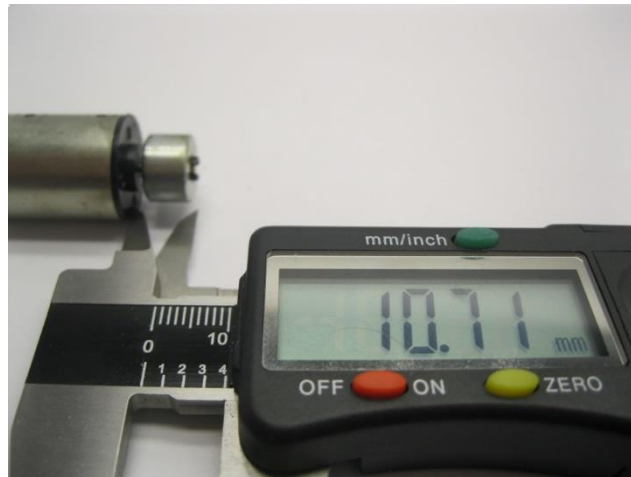
Maße prüfen Check dimensions Controleer de maatvoering
