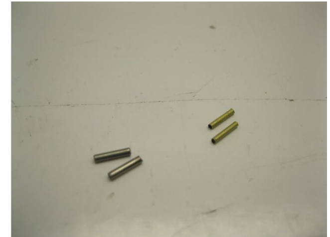
Die meisten Roco-Motoren haben 1,5 mm Wellen, einige alte Motoren 1,2 mm. Verwenden Sie nur die richtigen! Most Roco motors have 1.5 mm shafts, some old motors 1.2 mm. Only use the correct ones! De meeste Roco motoren hebben 1.5 mm assen, sommige oude 1.2 mm. Gebruik alleen de juiste!
