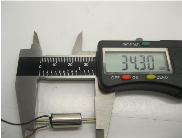
Maße prüfen Check dimensions Controleer de maatvoering
