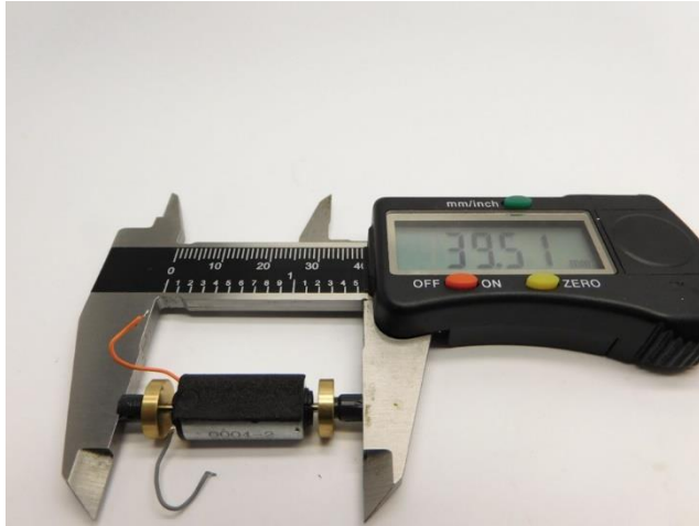
Maße prüfen Check dimensions Controleer de maatvoering
