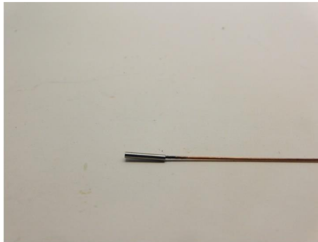
Tragen Sie Klebstoff auf die Innenseite des Teils Apply glue on the inside of the part Plaats alleen lijm aan de binnenzijde van de onderdelen
