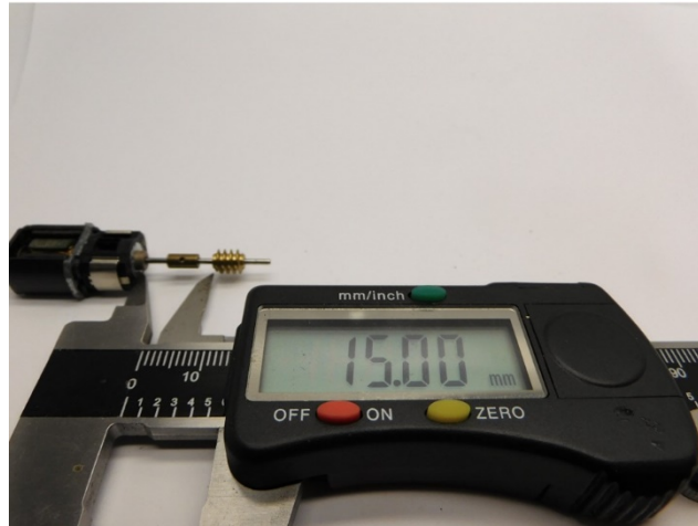
Maße prüfen Check dimensions Controleer de maatvoering
